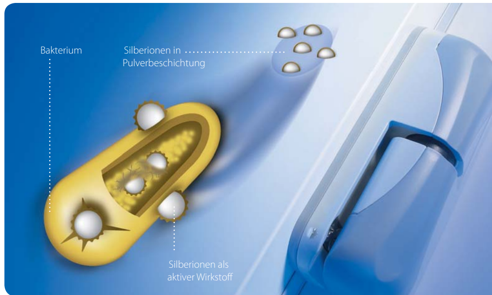
Ionen-Austausch durch Einwirkung von Umgebungsfeuchtigkeit
